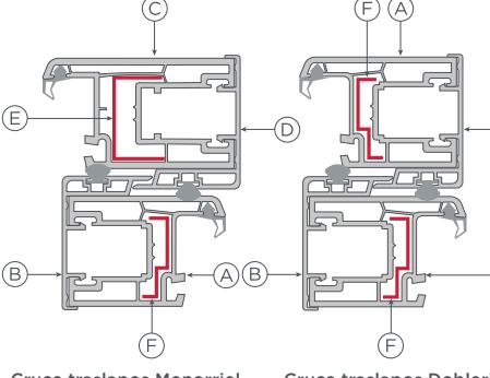
A.Termopanel, B.Poste T & Hoja exterior, C.Junquillo termopanel, D.Marco fijo, E.Ref. múltiple
