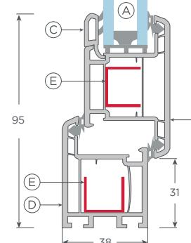
A.Termopanel, B.Hoja puerta corredera, C.Junquillo termopanel, D.Marco doble riel, E.Ref. hoja puerta corredera, F. Ref. marco corredera, G.Carro fijo, H.Riel de aluminio, I.Felpa 7x6 con fin seal.
